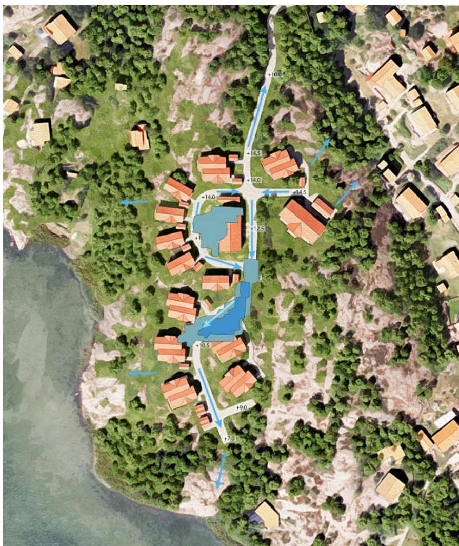
Maximalt vattendjup vid klimatanpassat 100-årsregn. Vattendjupet som redovisas går från 0,1–0,2 m till 0,1–0,2 m. Pilar visar föreslagna åtgärder.
